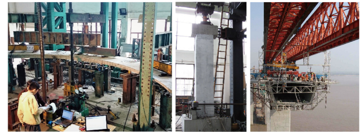
体外预应力混凝土曲线连续梁模型试验
