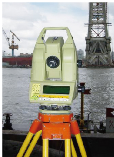
Leica TCA 全站仪应用于卢浦大桥施工监测
